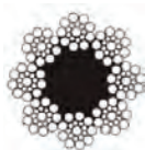
Construcția 8x19 Seale+NFC
